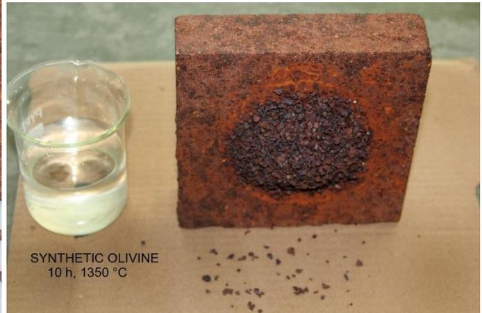
Thermtech 2-6 мм, после 10 ч. при 1350 °С Синт. оливин 1-5 мм, после 10 ч. при 1350 °С
